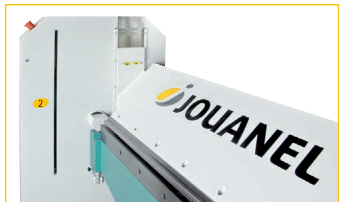
2 Protection avant par barrière immatérielle
