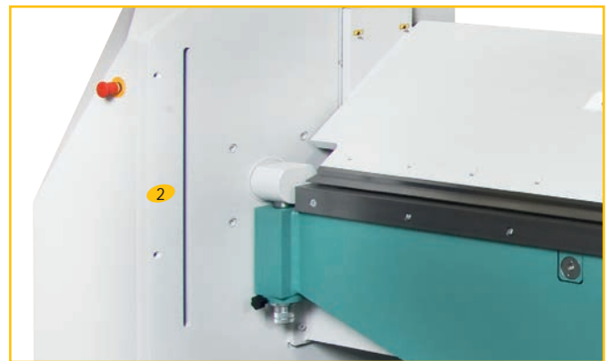
2 Protection avant par barrière immatérielle
