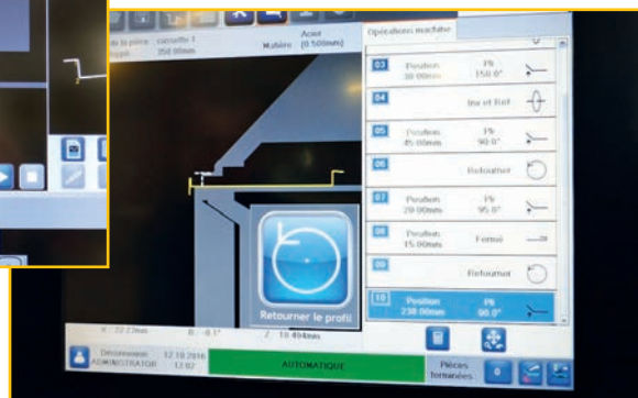
4 Détails de la réalisation d'une pièce Instructions pour l'inversion et le retournement de la pièce
