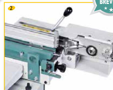
Ouverture latérale permettant la sortie du boudin sans sortir la baguette
